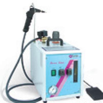
Il generatore di vapore SR 900 Steam è piccolo e compatto, con caricamento manuale, produce vapore a 5 bar, affidabile e idoneo a funzionamento continuo. Dimensioni: L220mm - P300mm - H500mm. Peso 10kg **Cod. 50900451**
