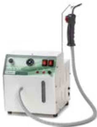
Generatore di vapore con caldaia in acciaio inox di grande dimensione, perfettamente coibentata, dotata di resistenza esterna allo scopo di evitare l'azione deleteria del calcare. L'erogazione del vapore avviene per mezzo di una pistola ed è a flusso regolabile. La pressione di utilizzo è 6 BAR e la temperatura dell'acqua è di 155°, parametri sufficienti per sgrassare e pulire a fondo qualsiasi superficie.
